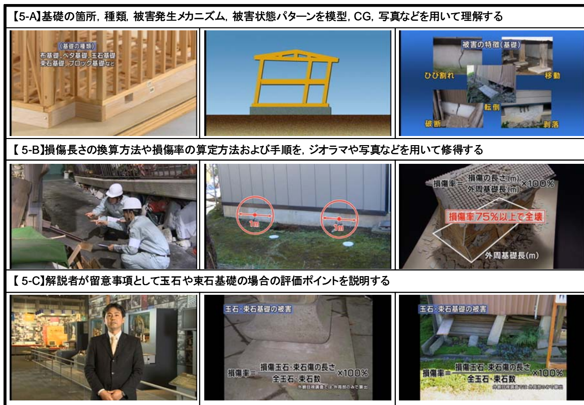
図 10 被害認定調査を対象としたビデオ教材概要 (事例:基礎被害の評価。5-A～5-C の記号は図 9 に対応。)
